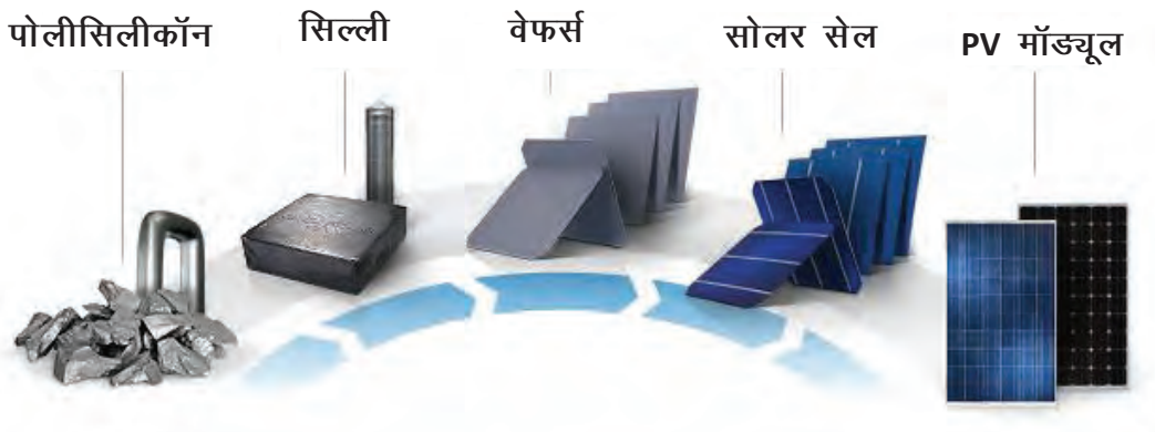
चित्र 1.1.3 सिलिकॉन से PV पैनल का निर्माण
